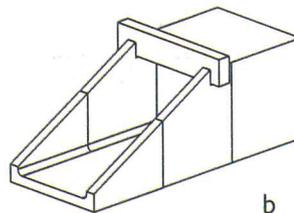
Endstück mit Anschnitt der Böschungs-
