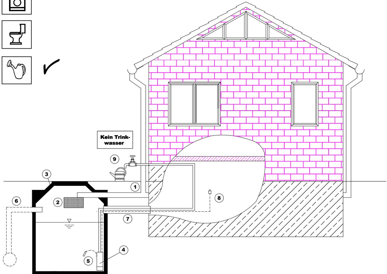
Alle Regenwasserleitungen der Dachentwässerung werden im Erdreich zusammengeführt und an den Zulauf (1) der Betonzisterne angeschlossen.
